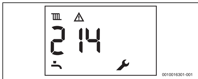
Rys. 81 Przykład: usterka niepowodująca blokady
