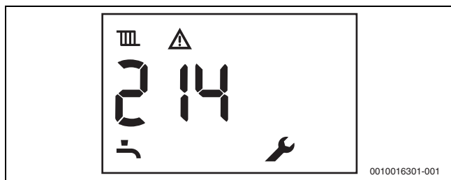
Rys. 75 Przykład: usterka niepowodująca blokady
