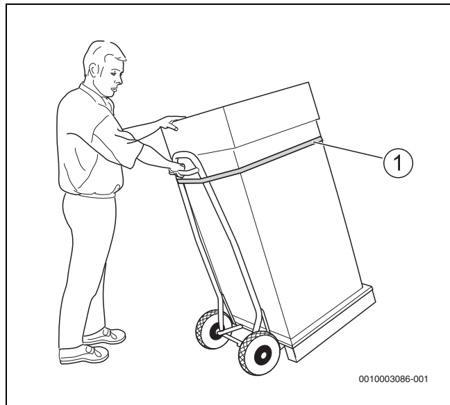
Rys. 6 Transportowanie wózkiem transportowym
