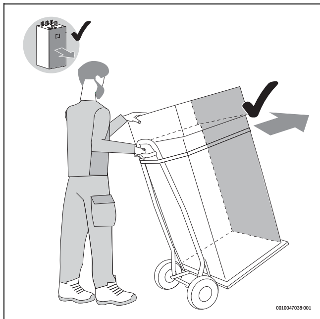
Rys. 9 Transport jednostki wewnętrznej wózkiem transportowym
